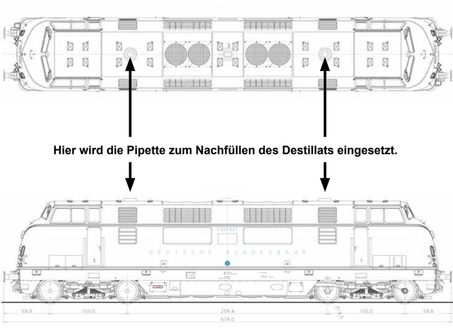
**Hier wird die Pipette zum Nachfüllen des Destillats eingesetzt.**
