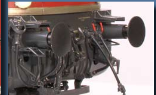
Neu: flexible Bremsschläuche die zudem auch noch kuppelbar sind
