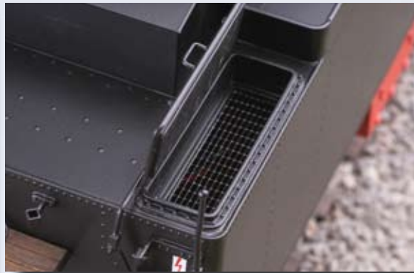
zu öffnende Wasserkastendeckel mit funktionsfähigen Stellstangen
