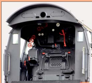
▲ Im fein detaillierten Führerstand gibt es eine Feuerbüchse, in der es gelegentlich synchron zum Sound des Kohle schaufelnden Heizers rot-gelb flackert.
