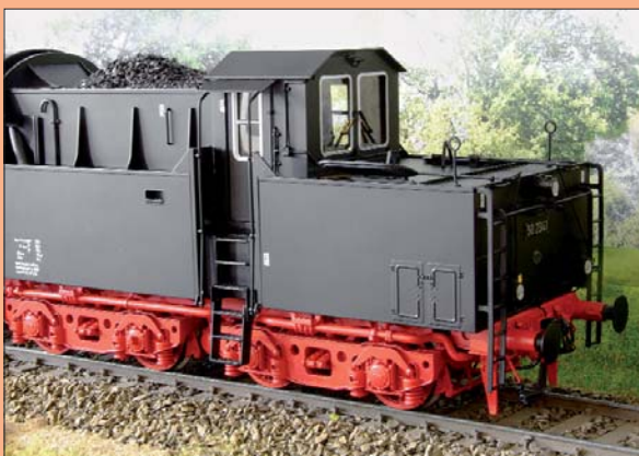
◀ Die Kabinentüren am Tender lassen sich nach innen öffnen, und der Aufenthaltsraum des Zugbegleiters hat eine zuschaltbare LED-Beleuchtung.
