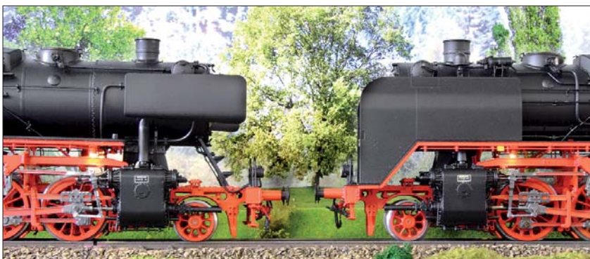
▲ Auf dieser Gegenüberstellung von 50 2341 (links) und 50 1544 sieht man gut, wie stark sich die beiden Schwesterloks trotz Großserienfertigung unterscheiden. Beispielsweise hat KM 1 den Loks auch unterschiedlich dicke Schornsteine spendiert.
