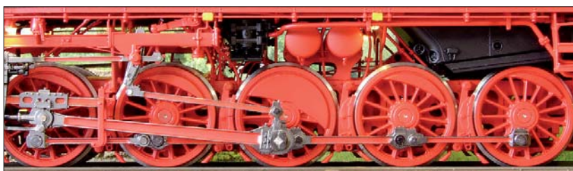
▲ Das Triebwerk der 50er bietet einen faszinierenden Durchblick, denn der Zinkdruckguss-Barrenrahmen ist vorbildgerecht durchbrochen.
