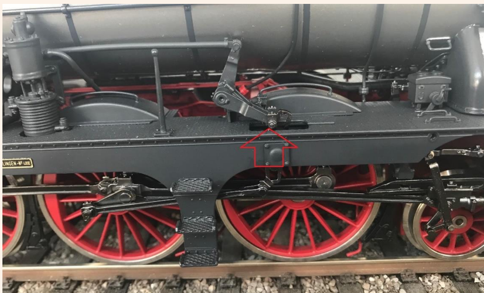
Korrekte Stellung des Aufwerfhebels bei Vorwärtsfahrt
