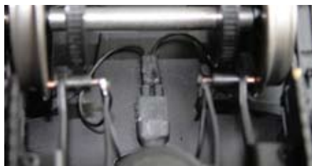
Bild 4: Der Kontaktstecker verbindet die Stromabnehmer des vorderen und hinteren Drehgestells.
