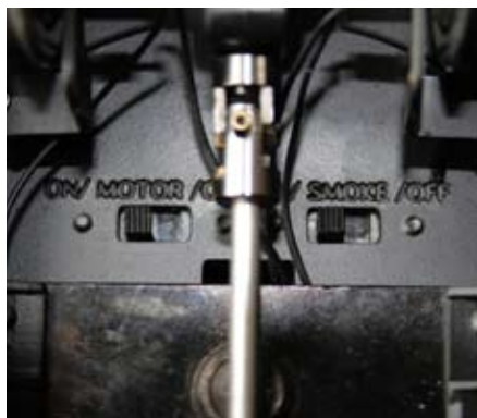
Bild 3: Der Schalter für den Motor (links) und der für den Rauchentwickler (rechts)
