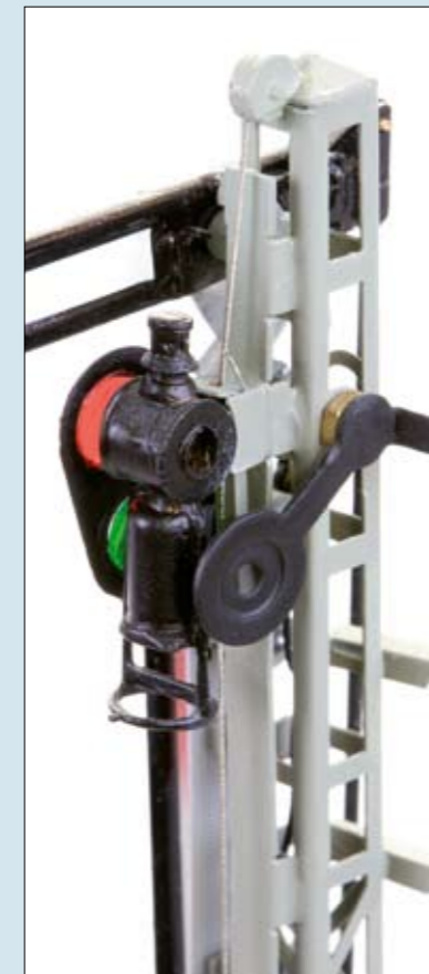
Umlenkrollen an der Mastspitze: Besig (links) wählte hier die verdeckte Form, KM1 zeigt ein filigranes Umlenkrad des Flaschenseils; gut zu erkennen: Die unterschiedliche Befestigungstechnik für die Mastblende
