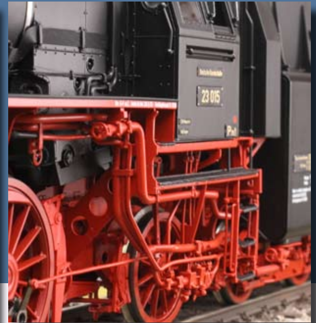
Antriebsgestänge der Zentralschmierung, und jede Menge Leitungen, Ventile und Stellstangen.
