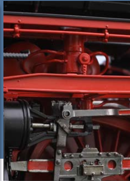
An beiden Seiten über dem Steuerungsträger befinden sich die Spurkranzschmierpumpen.
