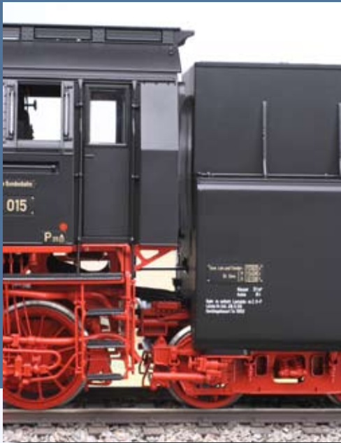
Mit diesem Lok-Tender-Abstand durch 1020 mm Radien? Geht nicht? Geht doch! Aber nur bei der „23er“ von KM1!
