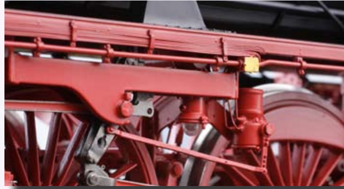
die ab der Epoche IIIb nachgerüstete Spurkranzschmierung
