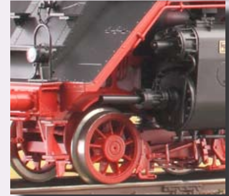
vorbildgerecht kleine Vorlaufräder - so können auch auf 1020 mm Radien die Kolbenstangenschutzrohre montiert bleiben.
