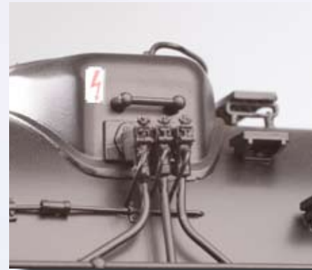
feine Druckluftleitungen an den Sandstredüsen
