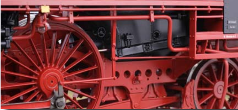
beweglicher Schmierpumpenantrieb, vorbildgerechte Rahmendurchbrüche und Aschkasten
