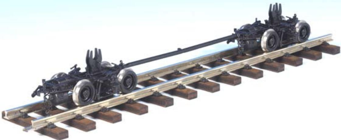
Messingmodell, kugelgelagerte Achsen, inklusive Kupplungsstangen, Achsaufnahmen für unterschiedliche Achsdurchmesser, bewegliche Joche. Packung enthält 2 Rollböcke (ausreichend für einen 2-achsigen Waggon)
