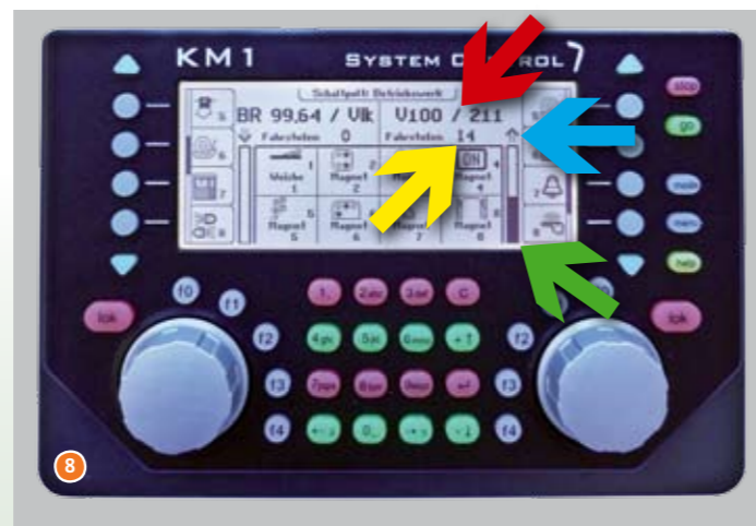
Anzeige von ausgewählten Loks für linken und rechten Fahrtregler und die eingestellte Fahrtrichtung (als Pfeil unterhalb der Lokbezeichnung)
