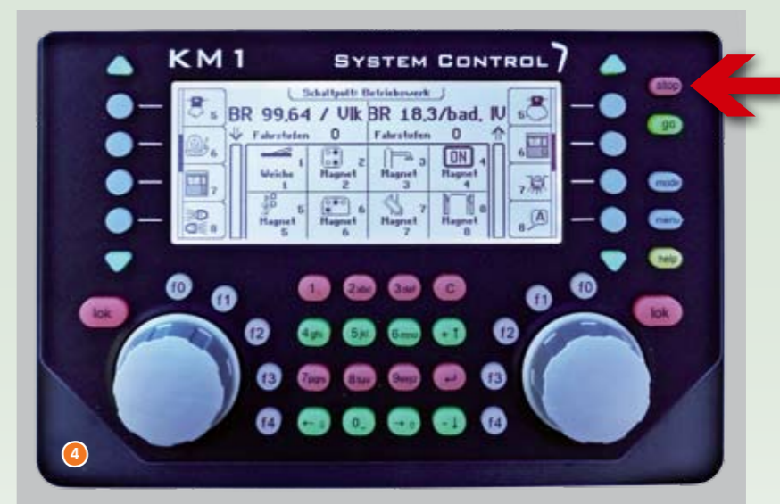
Der Begrüßungsbildschirm des SC7 (abhängig von den zuletzt im Fahrbetrieb verwendeten Einstellungen)
